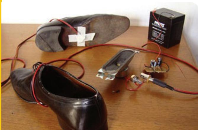
Figura 8: Zapatófono (Sapato com salto de madeira. Observe que se evita grudar o piezo numa parte que entrará em atrito direto com o chão, uma vez que isto resultaria num som muito agressivo, além de talvez danificar o captador). Fonte: <https://sonidocinico.files.wordpress.com/2014/10/zapatac3b3fonos-01-1.jpg>
